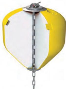
Las boyas de la serie Aqua están fabricadas con una carcasa exterior de PE rotomoldeado y llenas de espuma de poliestireno (EPS), lo que garantiza una resistencia a la compresión de 5 mH<sub>2</sub>O y una densidad de 25 kg/m<sup>3</sup>. La cadena continua de alta calidad termina en cada extremo mediante el uso de discos de terminación que están diseñados para evitar daños a la boya. La cadena se fija fácilmente mediante un grillete a la línea del ancla.
