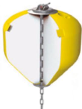
Las boyas de la serie Aqua están fabricadas con una carcasa exterior de PE rotomoldeado y rellenas de espuma de poliestireno (EPS), lo que garantiza una resistencia a la compresión de 5 mH<sub>2</sub>O y una densidad de 25 kg m<sup>3</sup>. La cadena continua de alta calidad termina en cada extremo de la boya mediante el uso de discos de terminación que están diseñados para evitar daños a la boya. La cadena se fija fácilmente mediante un grillete a la línea del ancla.
